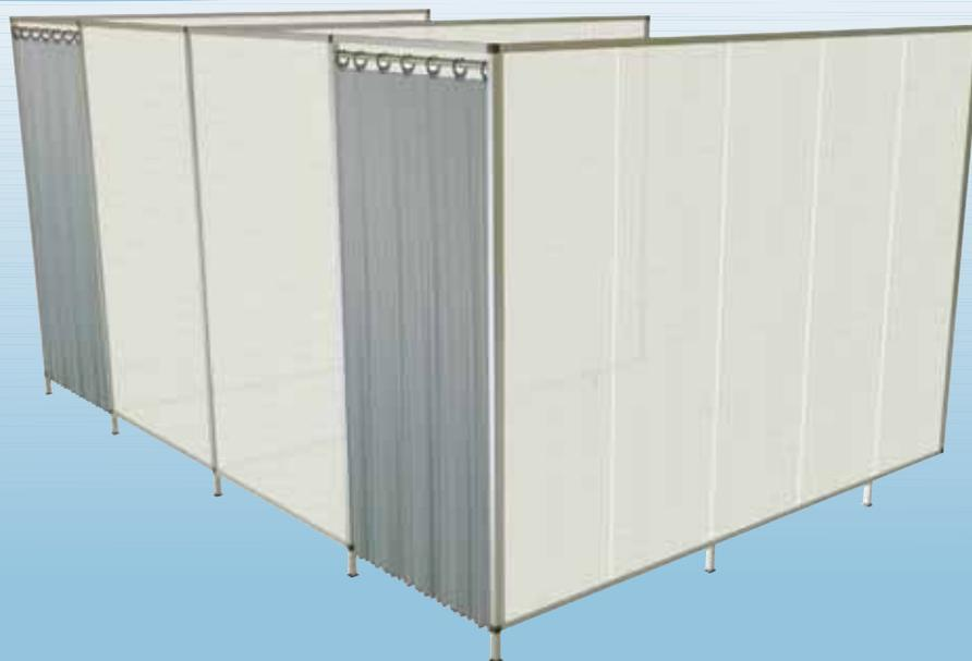
Parete divisoria composta da una struttura portante in alluminio anodizzato e pannelli traslucidi in policarbonato alveolare ad alta resistenza avente spessore 16 mm. e certificato con classe di reazione al fuoco 1. L'articolo è indicato per l'installazione a parete e può essere dotato di supporti a soffitto e a pavimento.
